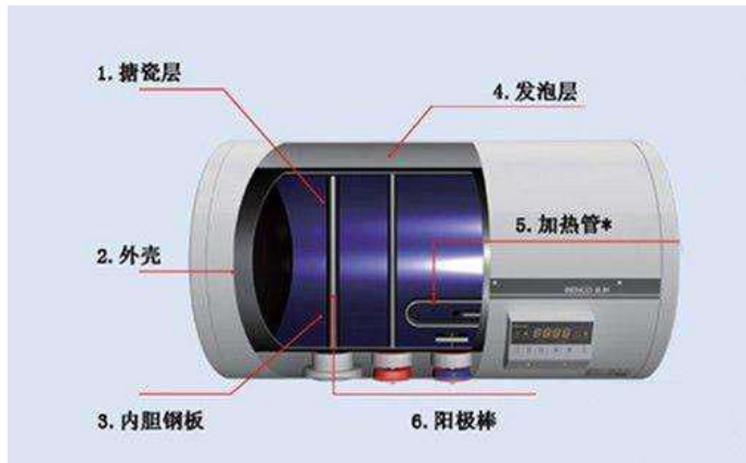
▲电热水器内部构造
