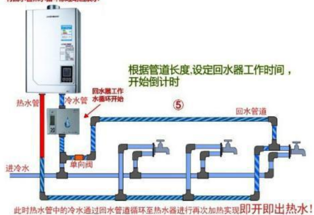
有回水管热水循环原理动画展示
